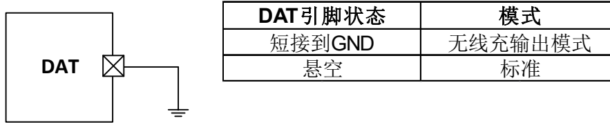
图 24 无线充模式选择电路图
