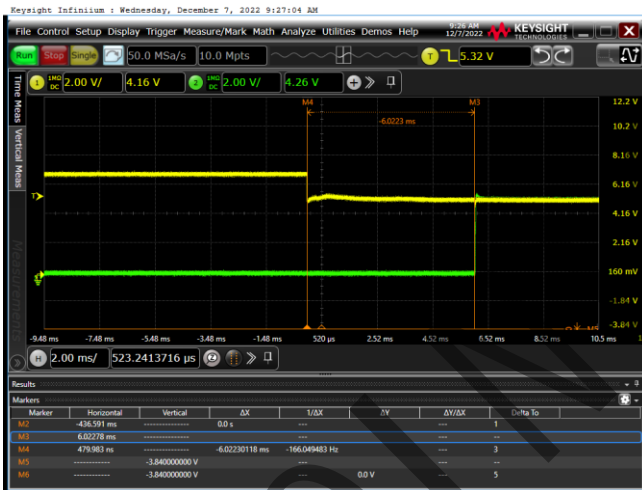
图7 VIN 过压恢复 (VIN=7V-5V)
