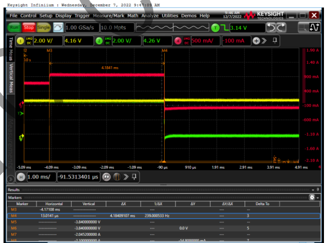
图8 输出过流保护 (IOUT=0.9A-1.2A)
