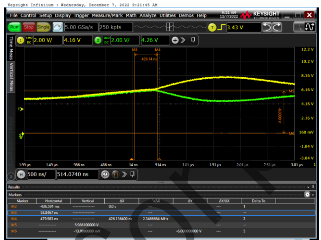
图6 VIN 过压保护 (VIN=5V-7V)
