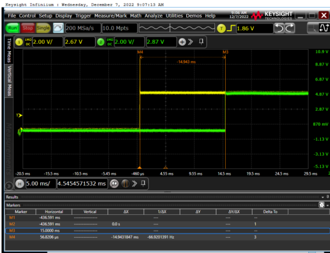
图5 VIN 正常上电启动 (VIN=5V)
